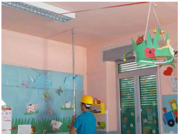
1,2. Analisi diagnostica delle problematiche di sfondellamento con battitura strumentale.
